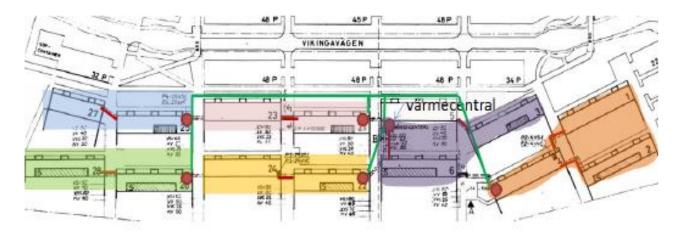
Figure 58. District heating network retrofit with 6 smaller substations. Source: Prime Project AB (2016): Kv Eddans pilothus – energi. Stadsdelsförnyelse avkvarteren Eddan 1&2 och Havamal 1&2, pilot. Lund: Prime Project AB.
